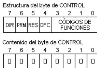
Fig. 3.28. Contenido del byte de control.
